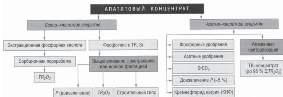
Рис. 3. Схема комплексного использования апатитовых концентратов при разных системах их вскрытия
