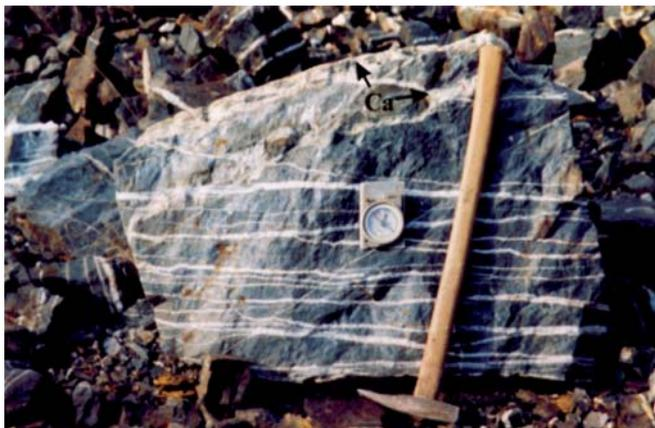
**Рис. 3. Типовой образец шеелитовых руд из центральной части штокверковой зоны Скрытая.** Субпараллельные прожилки кварц-шеелитового состава (иногда с апатитом, полевым шпатом, сульфидами) среди измененных габбро-пироксенитов (?) пересекаются кварц-карбонатными прожилками (Са). Фотография из коллекции А.О. Соболева
