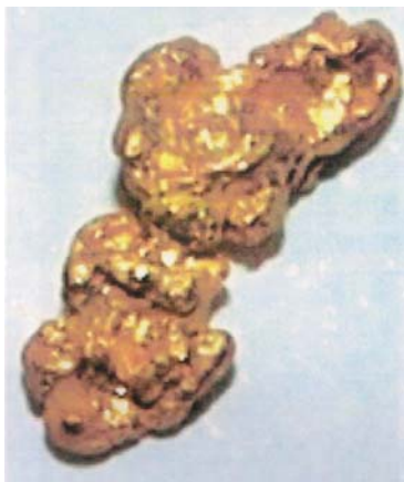
Рис. 2. Полиминеральный агрегат золота конкрециоидальной формы с включением лимонита. Проба Ng-29. Увеличение 30
