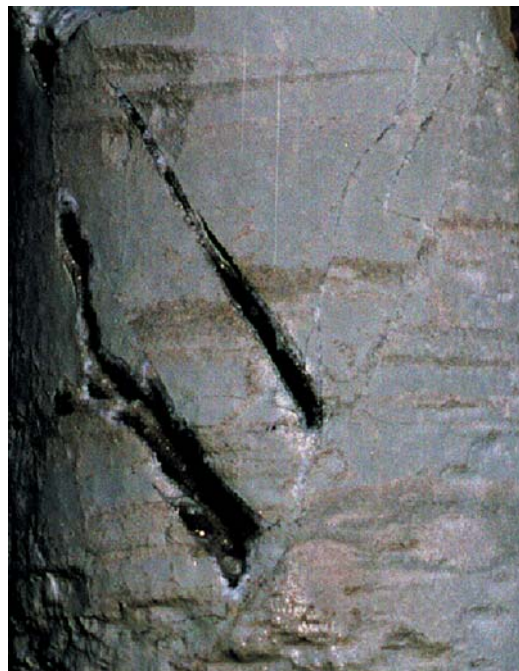
Рис. 3. Серия микровзбросов с амплитудой до 2 см и оперяющими зияющими трещинами отрыва с кальцитом. Керн скважины 488-440, глубина 134 м. Накынское поле
