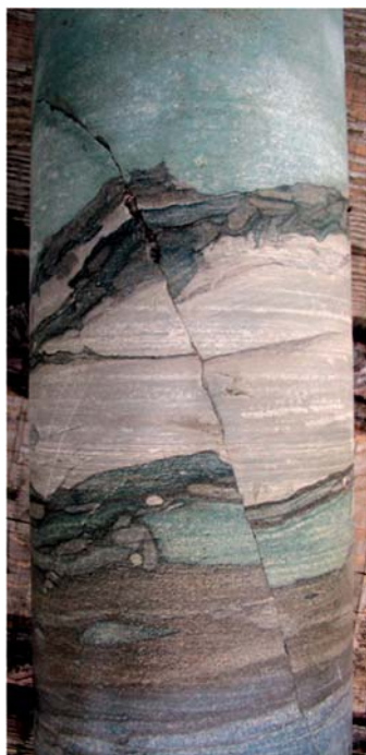
Рис. 2. Микровзбросо-сдвиг с уменьшающейся вверх вертикальной амплитудой смещения до 2 см. Керн наклонной скважины М-28 Мархинского месторождения, глубина 203 м
