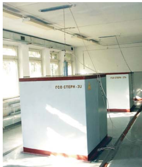
Рис. 2. Государственные стандартные образцы состава рудных тел естественных радионуклидов, пересеченных скважиной. Комплект СТЕРН-3К (калий), СТЕРН-3У (уран), СТЕРН-3Т (торий), СТЕРН-3С (калий, уран, торий)
