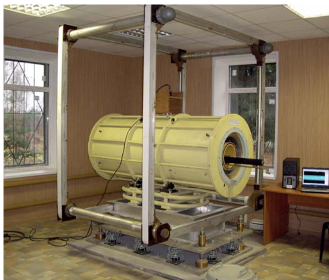
Рис. 3. Экранированная двухкомпонентная мера магнитной индукции (ЭДММИ) — исходный отраслевой эталон переменной магнитной индукции. Диапазон воспроизводимой магнитной индукции от 0,05 до 5000 нТл, диапазон рабочих частот от 0,01 до 10 000 Гц, погрешность воспроизведения значения магнитной индукции не более \pm 3\%
