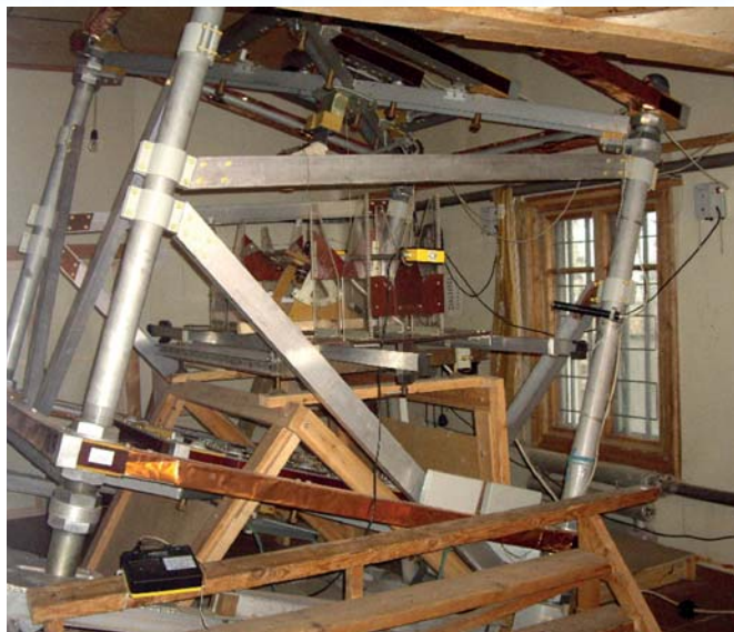
Рис. 1. Поверочная установка УПТМ-4 — исходный отраслевой эталон постоянной магнитной индукции — для тесламетров и магнитометров. Диапазон воспроизводимой магнитной индукции от 20 000 до 100 000 нТл, систематическая погрешность калибровки не более 0,2 нТл, случайная погрешность калибровки при времени измерения — 0,005 нТл (при времени измерений 1 с)
