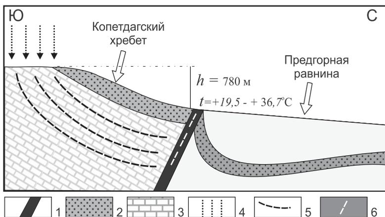
**Рис. 1. Гидростатическая модель формирования линии термальных источников Копетдага. По И.И. Никшичу [4].** 1 — Предкопетдагский разлом (линия термальных источников); 2 — водоупор (кварцевые песчаники); 3 — известняки сильно трещиноватые; 4 — воды метеорные; 5 — потоки подземных вод; 6 — потоки восходящих слаботермальных вод.  $h$  — высота над уровнем Предгорной равнины
