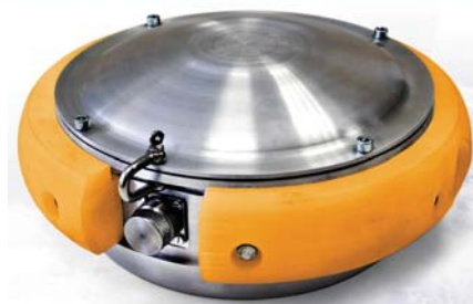
Рис. 1. Внешний вид снаряженного донного модуля Turtle-500
