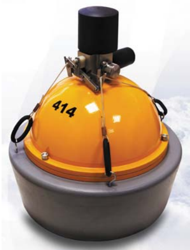
Рис. 2. Шельфовый сейсмический комплекс на основе автономных донных четырехкомпонентных самовсплывающих модулей «Дина»
