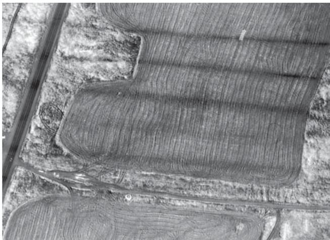
Рис. 3. Коридор магистральных газопроводов по данным ТИКАС (8–14 мкм, негатив)
