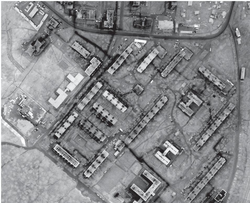
Рис. 2. Картирование тепловых сетей по данным ТИКАС (8–14 мкм, негатив)
