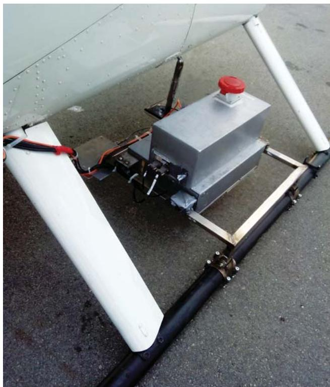
Рис. 1. Тепловизор ИКАР-002М на борту вертолета Robinson R-44
