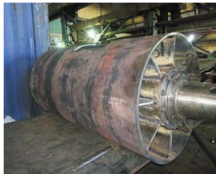
Рис. 1. Шнеко-аккумулятирующий буровой снаряд диаметром 750 мм
