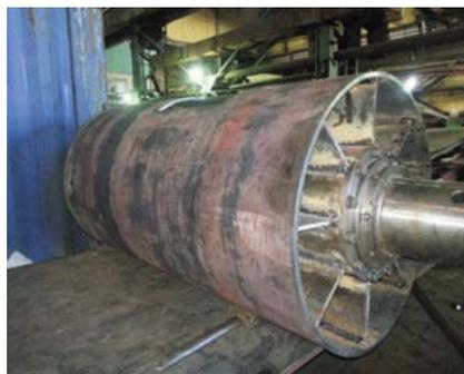
Рис. 1. Шнеко-аккумуляторный буровой снаряд диаметром 750 мм
