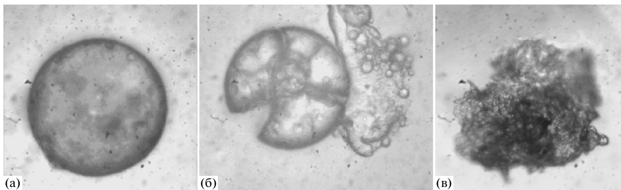
Рис. 3. Микрофотографии гидролитической деградации биополимерных микросфер на основе ПОБ с инкапсулированным хлорамбуцилом (световая микроскопия): а – 1, б – 15, в – 30 сут.
