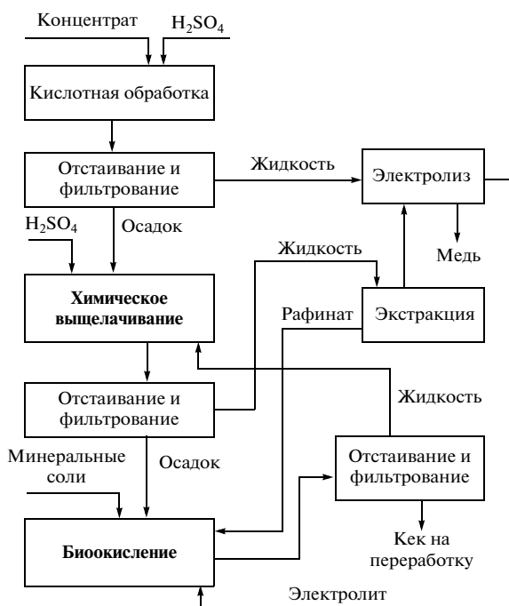
Рис. 4. Схема переработки сложного медного концентрата руды Удоканского месторождения.
