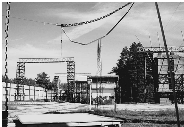
Рис. 6. Общий вид созданного омического делителя импульсного напряжения ОДН-2 на номинальное напряжение 2.5 МВ, подсоединенного в разрядной цепи г.к.и.н. к двухэлектродной системе “игла–плоскость” с длиной воздушного промежутка 3 м (верхний круглый заостренный стальной электрод \varnothing 25 мм этой системы размещен по центру ее нижнего плоского электрода из оцинкованной стали с габаритными размерами 5 \times 5 м).
