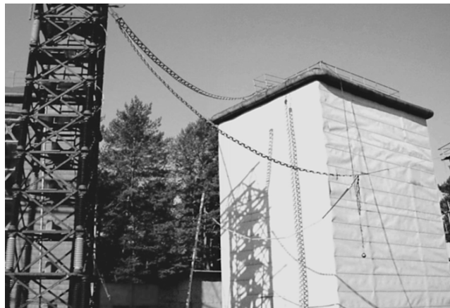
Рис. 3. Общий вид генератора для формирования на активно-индуктивной нагрузке стандартного коммутационного аperiodического импульса напряжения временной формы 250 мкс/2500 мкс с нормированными допусками амплитудой U_m до 2 МВ (слева видна изоляционная опора с нагрузочной емкостью C_H \approx 13.3 нФ, к верхнему потенциальному электроду которой подсоединены формирующий R_\Phi \approx 4.28 кОм и токоограничивающий R_T \approx 4.59 кОм резисторы, а справа — прямоугольная конструкция генератора ГИН-4).
