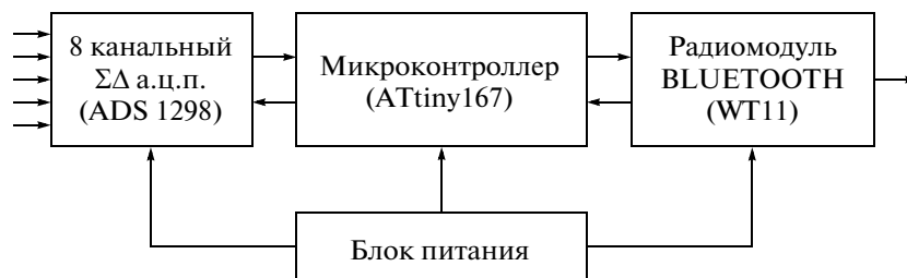
Рис. 2. Блок-схема устройства MD226.
