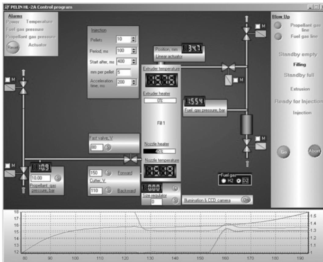
Рис. 4. Основное программное окно системы управления работой инжектора.
