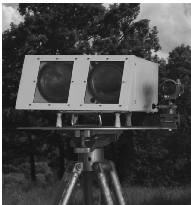
Внешний вид измерителя высоты нижней границы облачности.
