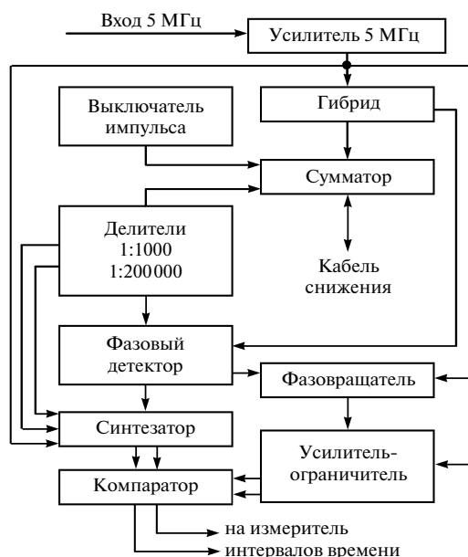
Рис. 3. Структурная схема наземной части измерителя электрической длины кабеля.
