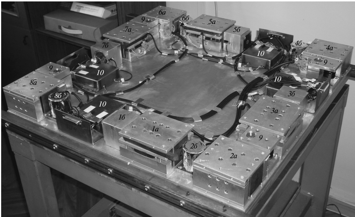
Рис. 3. Внешний вид несущей плиты с установленными на ней сервисными двигателями 1a-8a , акселерометрами 16-86 , упругими опорами 9 и усилителями 10 сигнала акселерометров.
