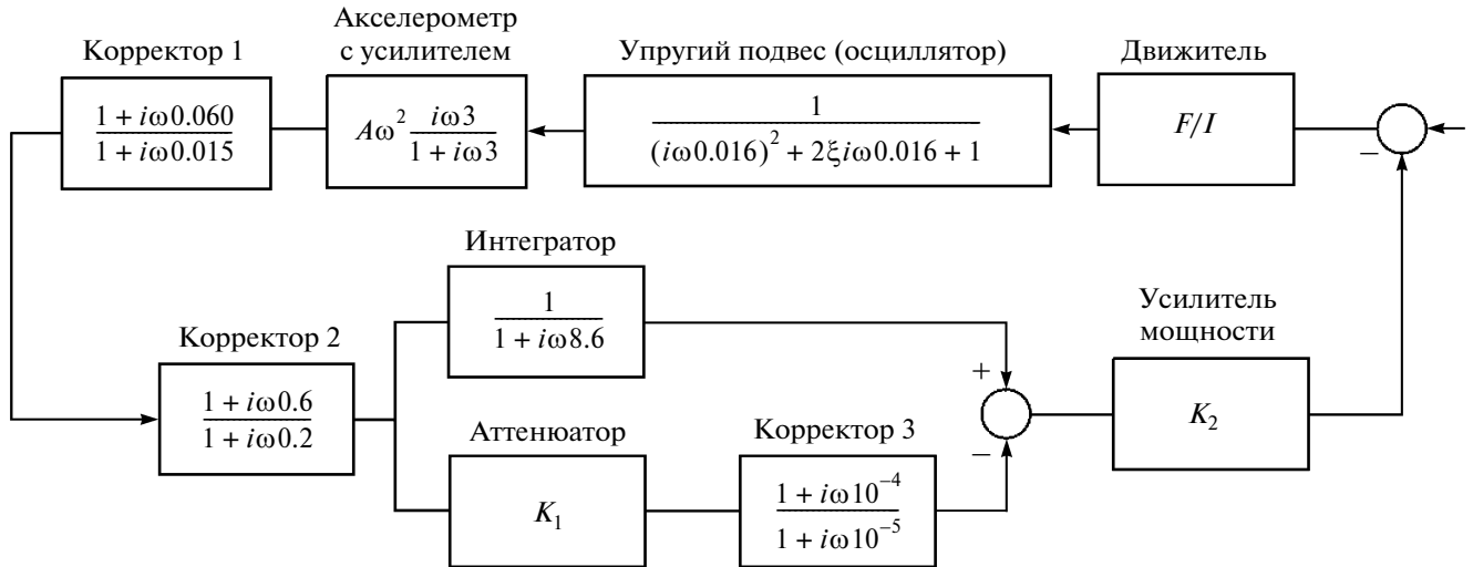
Рис. 4. Структурная схема цепи управления одной из шести мод колебаний несущей плиты.
