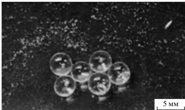
Рис. 1. Внешний вид шариков из смеси ароматических углеводородов, замороженных в жидком азоте.
