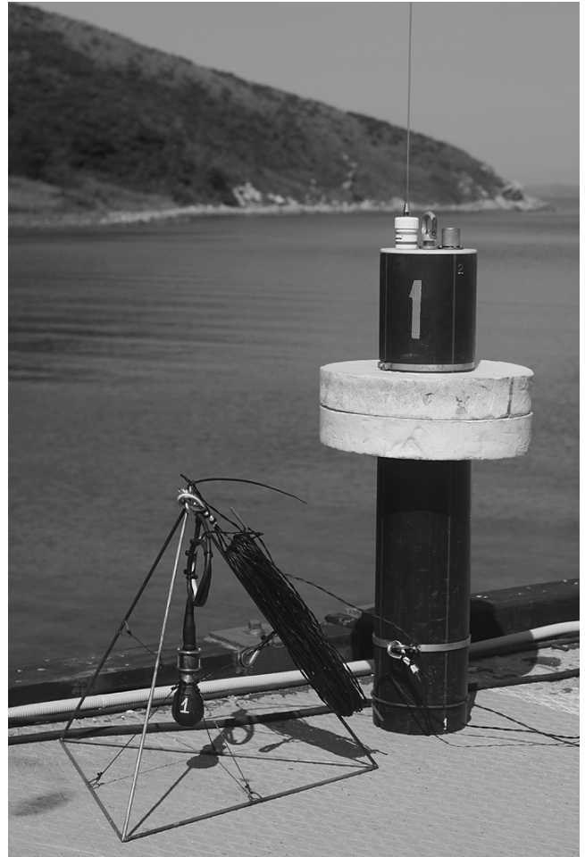
Рис. 1. Внешний вид радиобуя.
