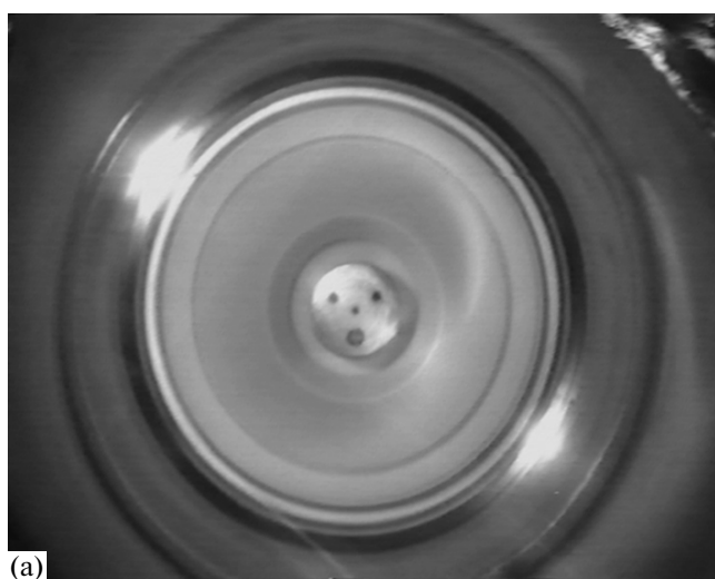
Рис. 5. Видеорегистрация предпробойных явлений на поверхности изолятора: а – опорный кадр без предпробойных явлений; б – кадр, полученный вычитанием опорного.
