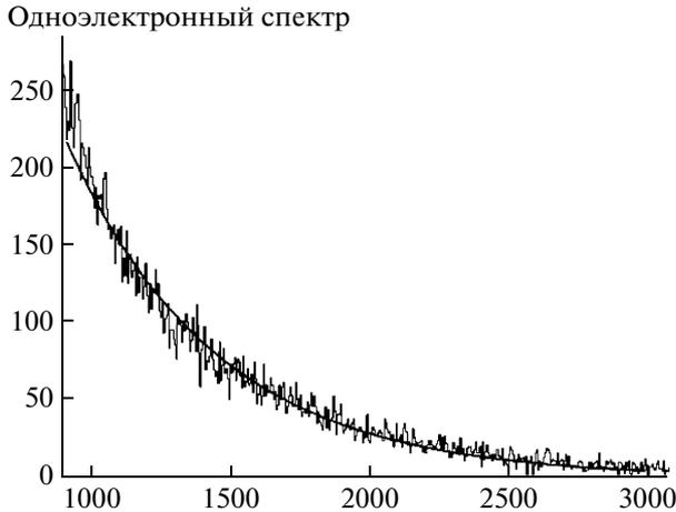
Рис. 6. Амплитудный одноэлектронный спектр, полученный при освещении проволоки  $\varnothing 70$  мкм галогеновой лампой (фотоэффект).
