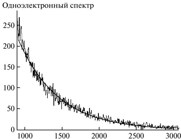
**Рис. 6.** Амплитудный одноэлектронный спектр, полученный при освещении проволоки Ø70 мкм галогеновой лампой (фотоэффект).
