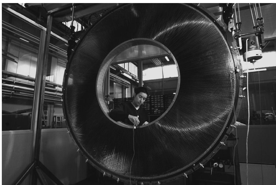
Рис. 7. Монтаж модуля торцевой части т.д.п.и. установки ATLAS в CERN (CERN-EX-9804025 02).
