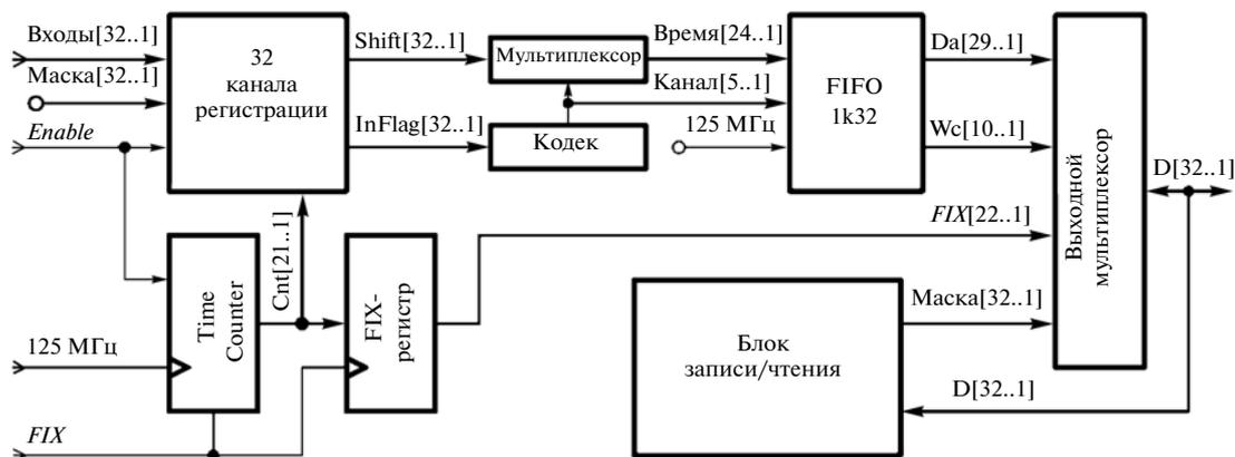
Рис. 10. Структурная схема одного узла регистрации модуля V-12.
