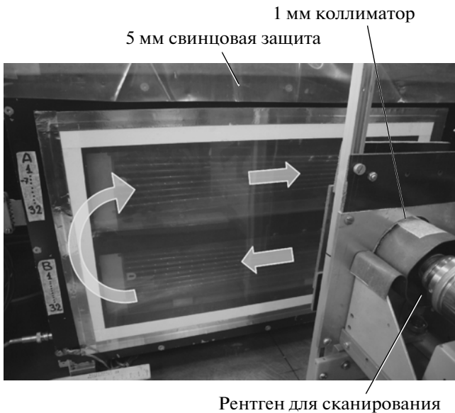
Рис. 3. Фотография детектора в установке. Стрелками указано направление газового потока.
