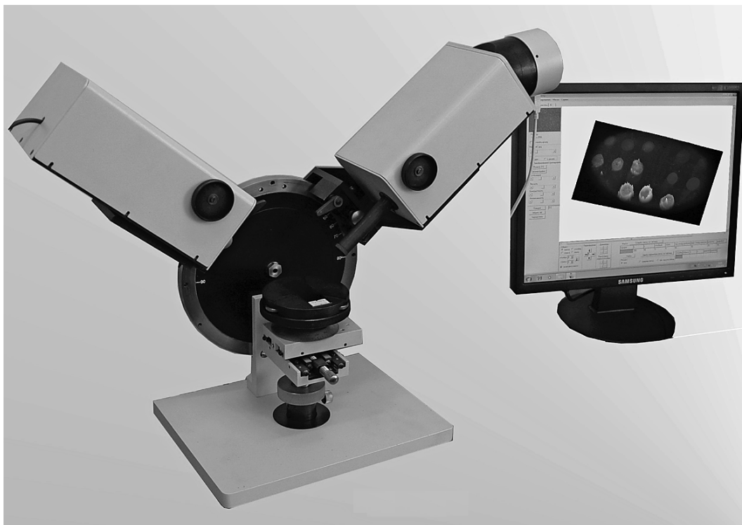
Рис. 2. Фотография матричного эллипсометрического комплекса.
