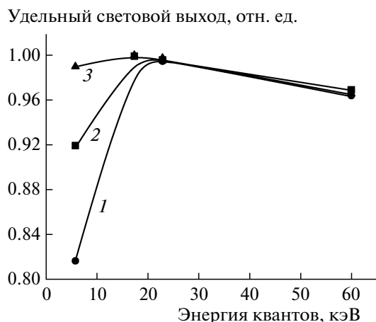
Рис. 4. Зависимость удельного светового выхода от энергии квантов для кристаллов NaI:Tl [128]: 1 – традиционный способ полировки; 2 – полировка с применением кремнийорганических жидкостей; 3 – зеркальный скол.
