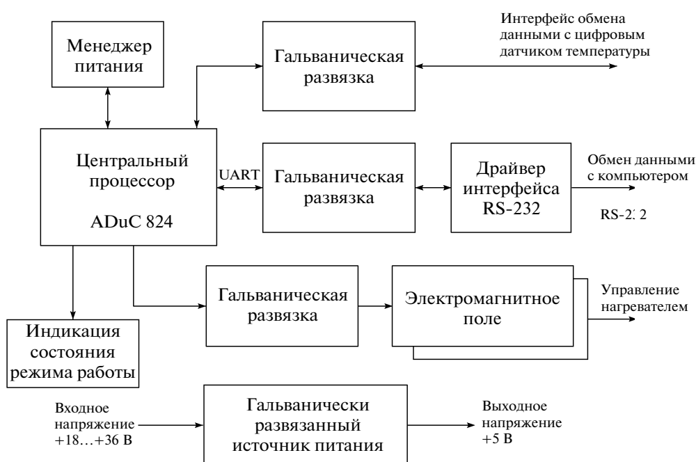
Рис. 1. Функциональная схема терморегулятора.
