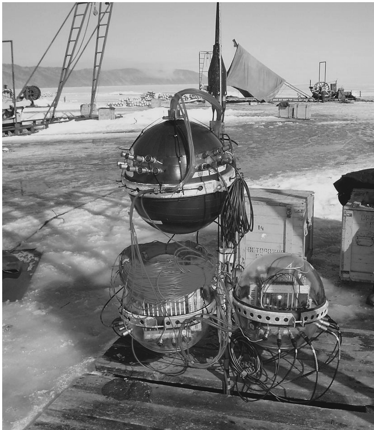
Рис. 9. Вид одного из глубоководных модулей наносекундных источников света, смонтированного на кабель-тросе одной из внешних гирлянд и полностью готового к окончательному погружению.
