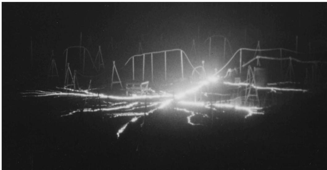
Рис. 9. Свечение искровых каналов в окрестности стержневого заземлителя.
