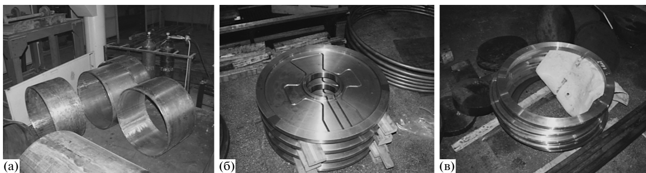
Рис. 19. Заготовки элементов ускоряющей структуры: а – обечайки; б – торцевых стенок; в – соединительных фланцев обечайки.
