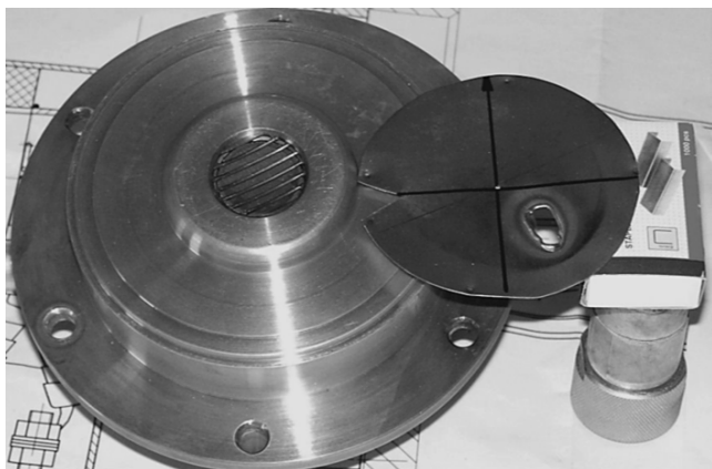
Рис. 31. След пучка на фольге и катодно-сеточный узел (диаметр сетки 20 мм).
