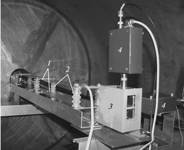
Рис. 4. Фотография селектора скоростей. 1 – отклоняющие пластины; 2 – высоковольтные изоляторы; 3 – датчик частиц с двумя группами колец Фарадея; 4 – зарядочувствительные усилители датчиков частиц.
