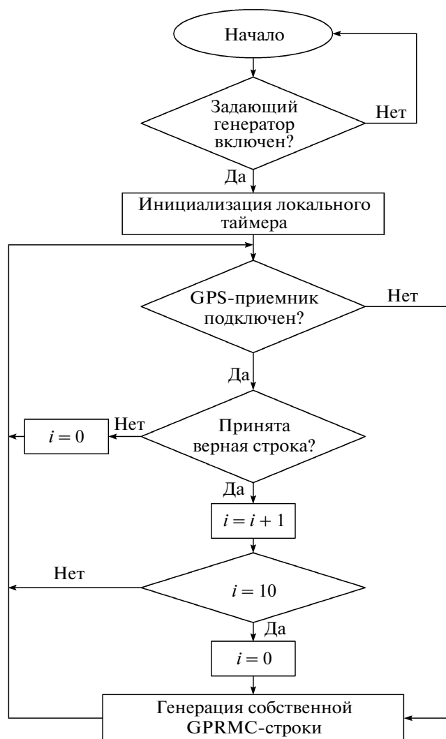
Рис. 3. Блок-схема программы микроконтроллера эмулятора GPS-приемника.
