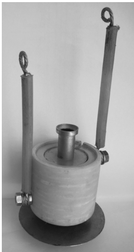
Рис. 3. Внешний вид импульсного соленоида с азотным охлаждением.
