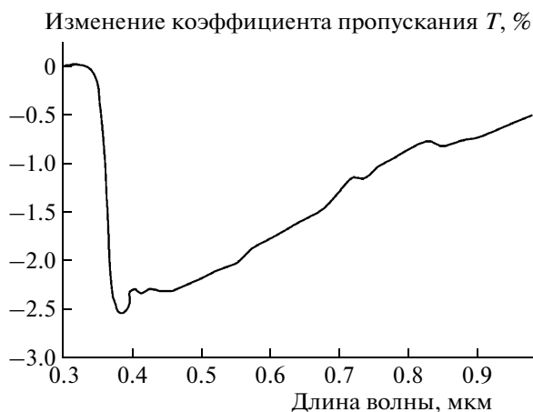
Рис. 6. Изменение спектрального коэффициента пропускания стекла К-8 при воздействии потока микрометеоритов.
