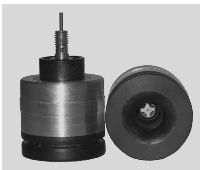
Рис. 2. Прецизионные торцевые заглушки дрейфовых трубок.
