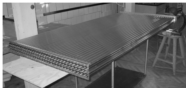
Рис. 12. Фотография камеры из дрейфовых трубок на основе лавсанового корпуса.
