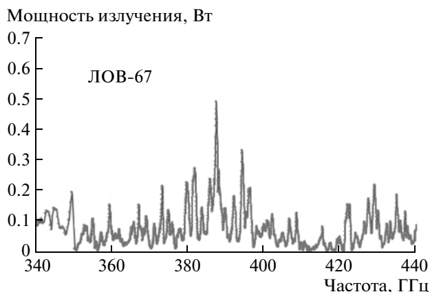
Рис. 3. Спектр излучения и рабочая спектральная область л.о.в. ЛОВ-67 (340–440 ГГц).
