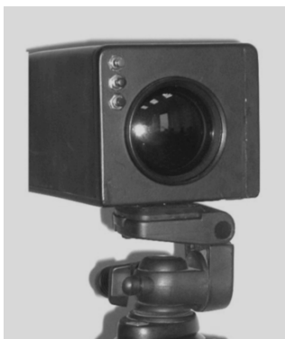
Рис. 2. Внешний вид тепловизионной системы со стандартным объективом.
