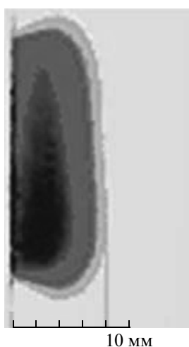
Рис. 5. Распределение плотности окрашенного слоя после взаимодействия пучка с плазменно-диэлектрической структурой.
