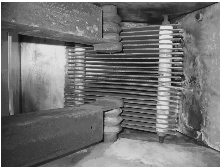
Рис. 8. Общий вид размещения рельсотрона и решетки из диэлектрического материала в камере дугогашения.
