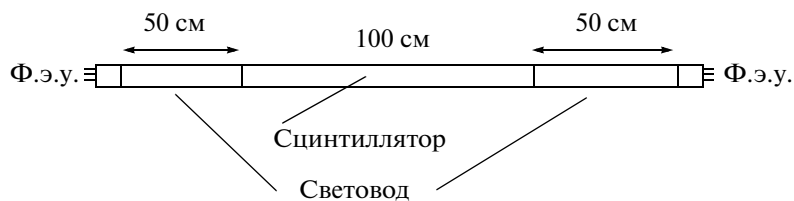
Рис. 1. Принципиальная схема экспериментальной сцинтилляционной ячейки.
