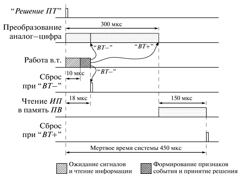
Рис. 2. Временная диаграмма связи работы триггера и системы сбора данных детектора КЕДР.
