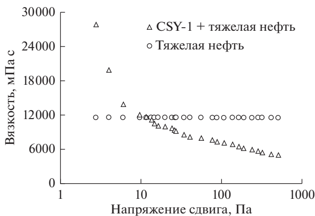
Рис. 6. Зависимость вязкости эмульсий от напряжения сдвига при 50°C.
