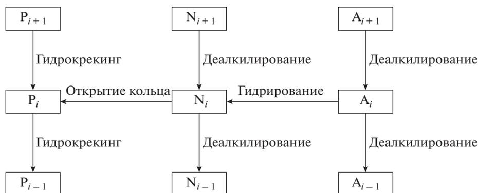
Рис. 2. Реакционная схема процесса ГК, где P – парафиновые, N – нафтеновые и A – ароматические углеводороды, индексы  $i - 1$ ,  $i$  и  $i + 1$  обозначают более легкие, средние и более тяжелые псевдокомпоненты соответственно.
