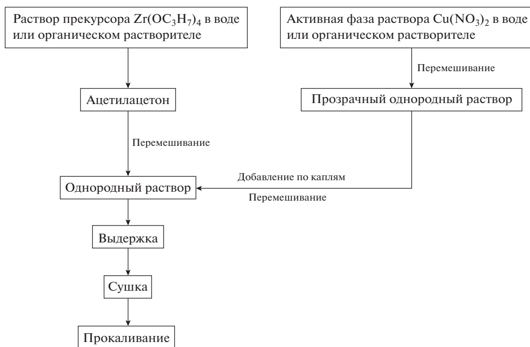
Рис. 7. Стандартный золь-гель метод для синтеза катализаторов на основе меди.
