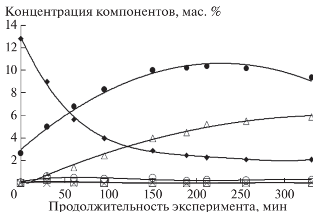
Рис. 2. Превращения АдДФО на AlCl_3 при 333 К: (●) адамантан; (□) o -1-АдДФО; (△) m -1-АдДФО; (×) m -2-АдДФО; (◆) n -1-АдДФО; (○) n -2-АдДФО.
