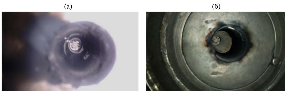
**Рис. 4.** Образование сажи в процессе парциального окисления: (а) состояние реакторной трубы после эксперимента № 2 (природный газ), (б) состояние реакторной трубы после эксперимента № 6 (чистый метан).
