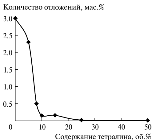
Рис. 19. Количество твердых отложений при пиролизе топлива JP-8 с добавками тетралина (450 °С, 4 ч) [82].
