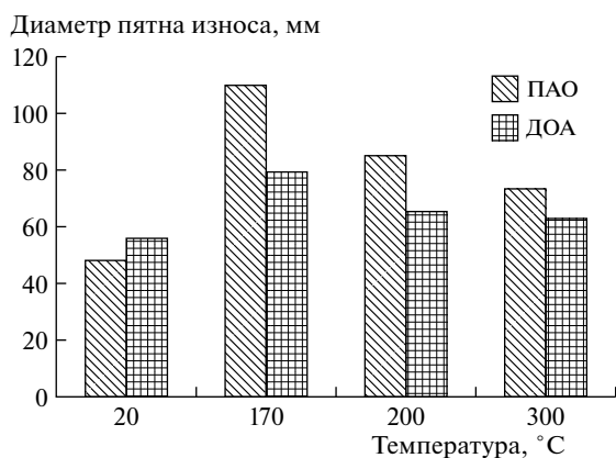
Рис. 6. Изменение диаметра пятна износа для образцов, окисленных при разной температуре ПАО и ДОА.
