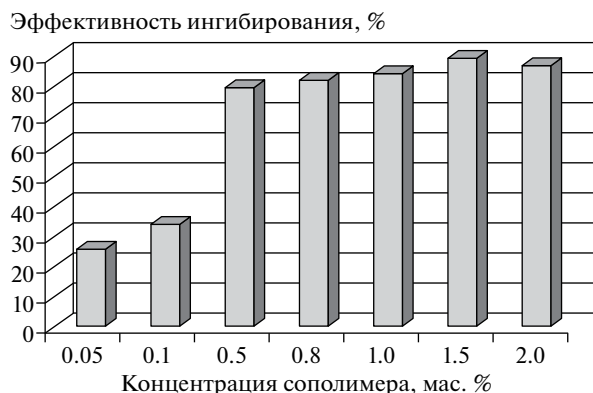
Рис. 3. Зависимость эффективности ингибирования набухания глины от концентрации сополимера.
